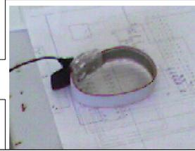
Ce petit bracelet permet de manipuler des composants électroniques sans risquer de les abîmer car il décharge le corps humain de son électricité statique en le mettant à la masse.
